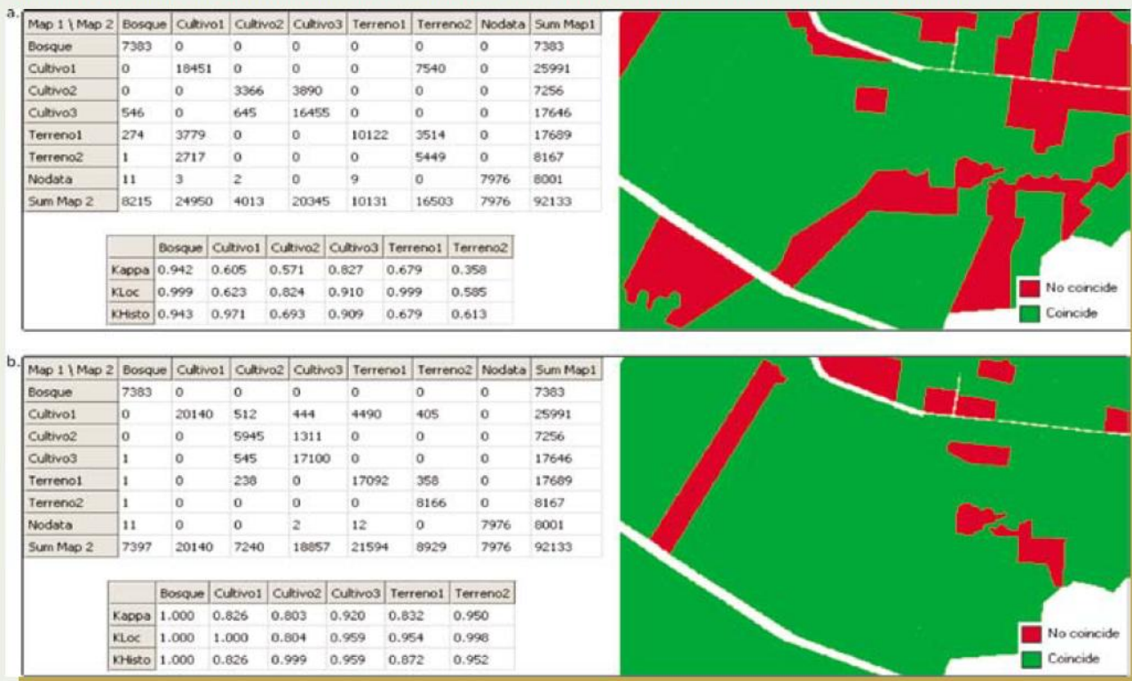
Figura 5. Evaluación de exactitud temática de la clasificación digital a) clasificador basado en píxel y b) clasificador basado en objetos
